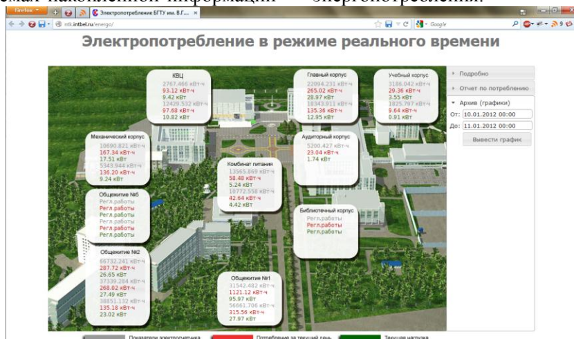
Рис. 1. Интерфейс системы мониторинга электропотребления БГТУ им. В.Г. Шухова
