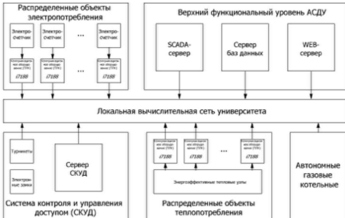
Рис. 2. Структура АСДУ распределенными энергоресурсами
