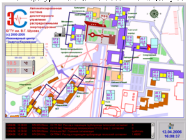
Рис. 2. Интерфейс АРМ диспетчера АСДУ
